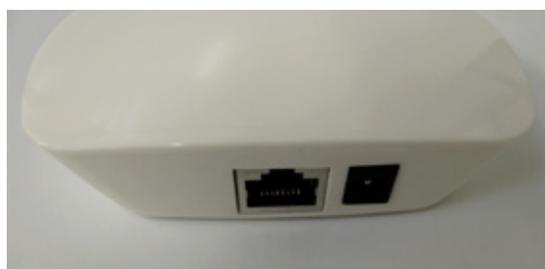
Le SR-2818WiN est un convertisseur. Il convertit les signaux WiFi en signaux RF et est compatible avec toute la gamme des contrôleurs SR-1009. On peut donc contrôler, grâce à ce convertisseur très compact, un contrôleur via une application Android ou iOS gratuite.
