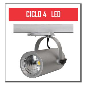
Projecteur LED orientable pour rail TRI. Module LED 20W 1670Lm 4000K. Faisceau 24°. Convertisseur intégré (non dimmable). IRC >80. Durée de vie 35.000 heures.
